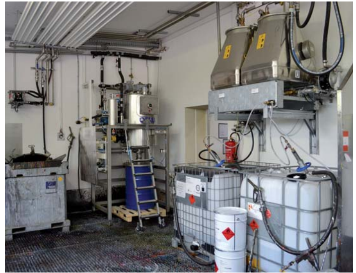
Lösemittelaufbereitungsanlage ASC-150 24 kW bei JG Service Bild: OFRU
