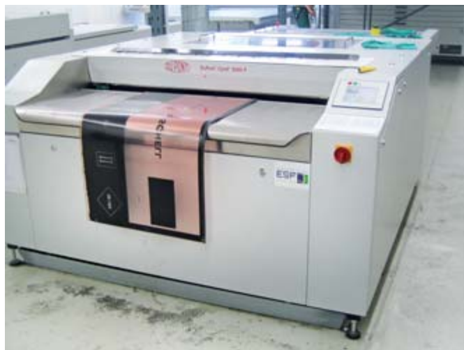
Nach dem Imaging-Vorgang werden die photopolymeren Flexodruckplatten in einem DuPont Belichter/Finisher belichtet und anschließend in einem Plattenverarbeitungssystem weiterverarbeitet.
