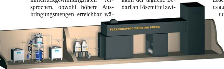
Destillationsanlage *ASC-150* in Anbindung mit einer Druckmaschine.
