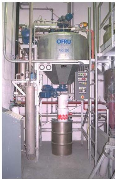
Bild: Destillationsanlage ASC-200 im EX-Raum
