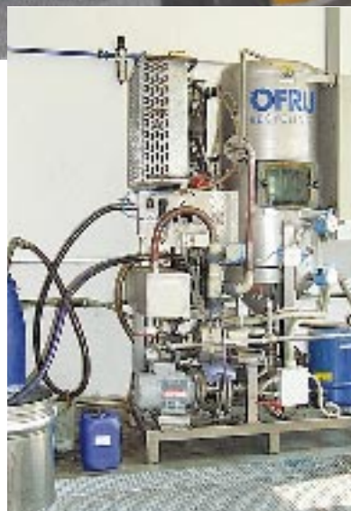
Bild 3: Die Vakuumverdampfungsanlage WSC-700 ist für größere Destillationsmengen ausgelegt. Ihr Durchsatz liegt bei 32 l/h.
